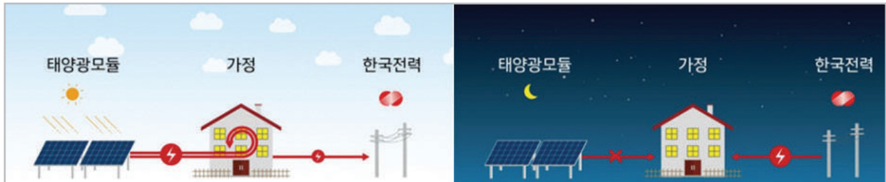
낮에는 태양광발전으로 전력을 만들어 직접 소비하고 한전에 역송합니다. 그리고 밤이 되면 발전을 멈추고 한전에서 전력을 공급 받아 소비하게 됩니다. 에스에너지(www.s-energy.com)
